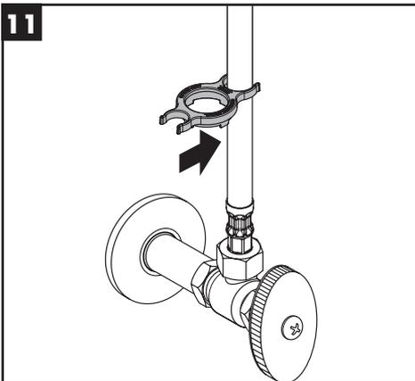
**Set the High Temperature Limit Stop / Réglage de la butée limite d'eau chaude / Ajuste el tope de límite de alta temperatura**
